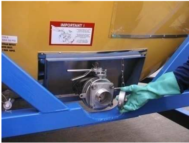
ภาพที่ 6 จุดเชื่อมต่อไหลสารเคมี Acetic anhydride ออกจาก Isotank
