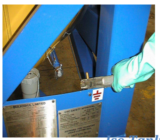
ภาพที่ 5 ขั้นตอนการต่อสายกราวด์ของ Isotank
