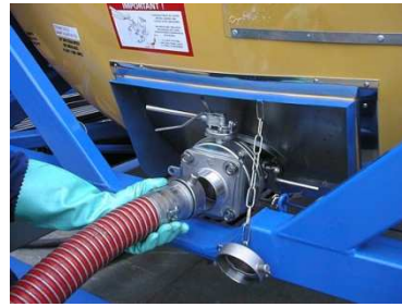
ภาพที่ 6 จุดเชื่อมต่อไหลสารเคมี Acetic anhydride ออกจาก Isotank
